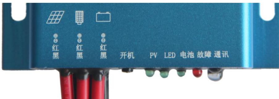
PV、LED、电池为绿色 LED 指示灯，故障为红色 LED 指示灯，通讯无指示灯。
